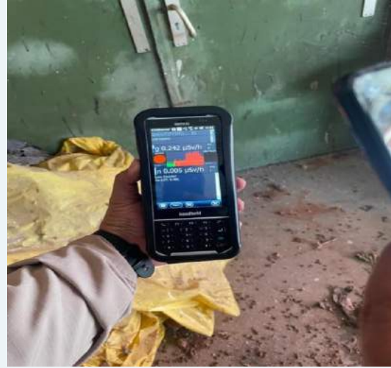
Gambar 29. Pengukuran laju dosis di Gedung 10
