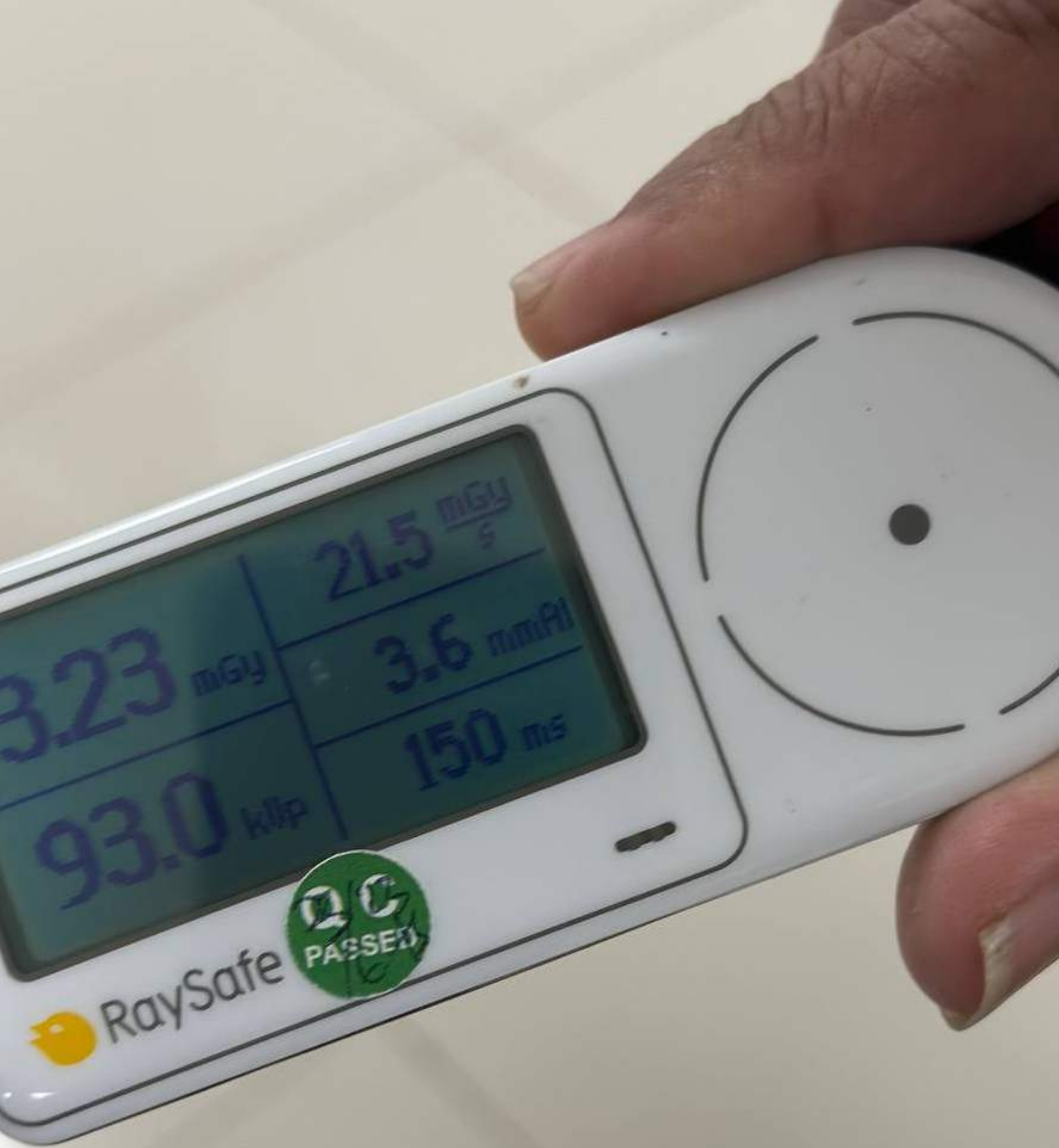
Pengukuran tingkat Radiasi Pada Fasilitas Kesehatan
