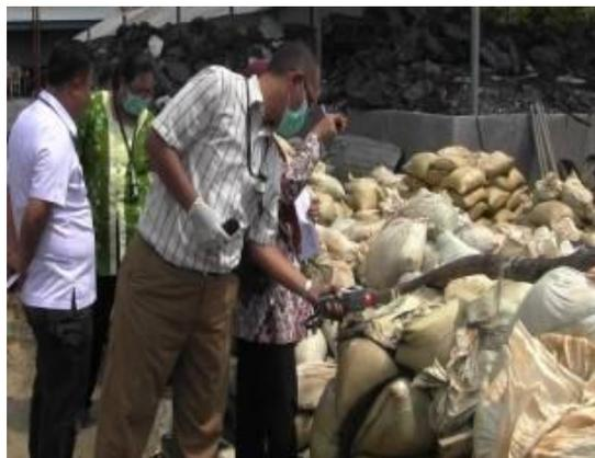
Gambar 12. Pengukuran paparan TENORM
